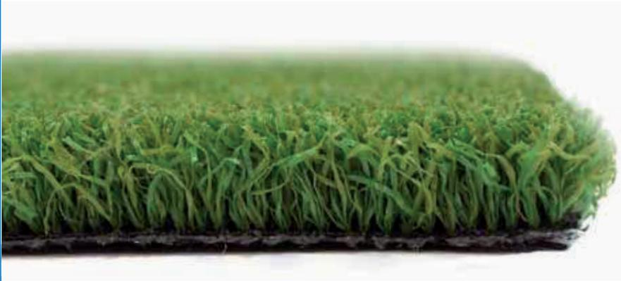
Monofilamento de dos colores, altura de 16mm, 5.500 Dtex, 84.000 puntadas/m<sup>2</sup>, galga 3/16 y peso total de 3.198 g/m<sup>2</sup>.
