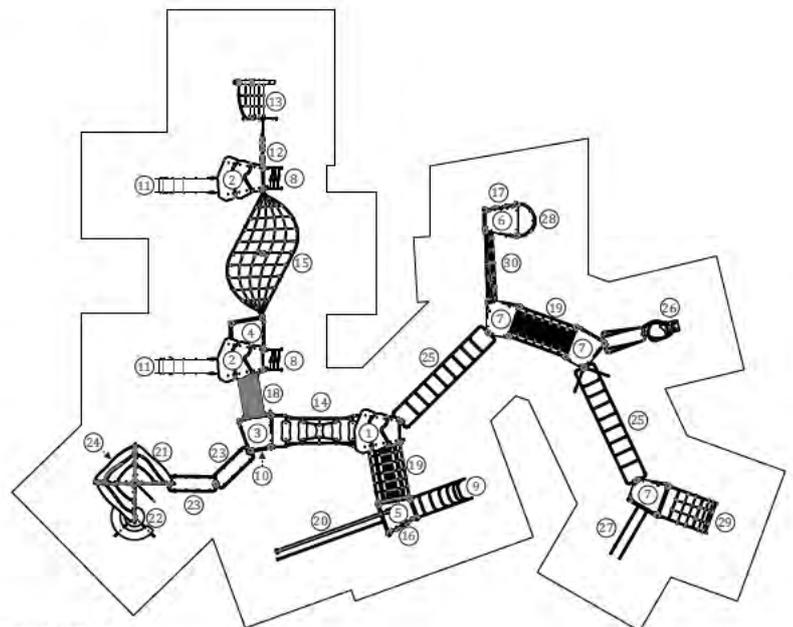
Utilização do equipamento sujeito a condições vigiadas; Zona de segurança: Área mínima requerida pela norma EN 1176-1,6
