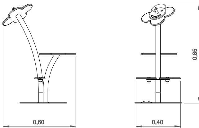
Utilização do equipamento sujeito a condições vigiadas; Zona de segurança: Área mínima requerida pela norma EN 1176-1,6
