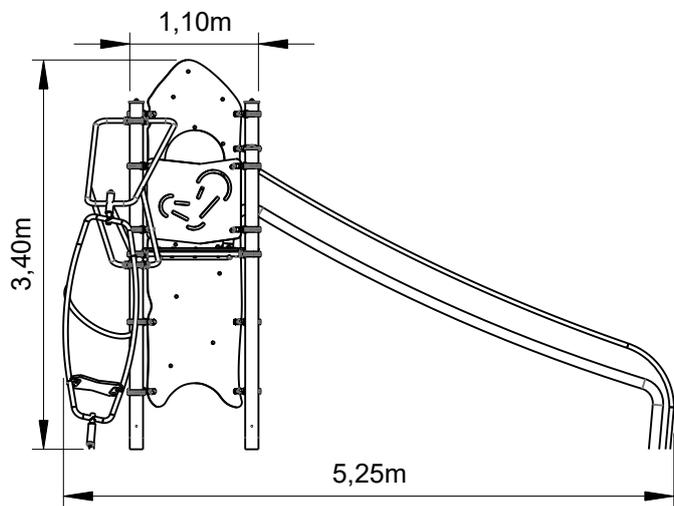
Utilização do equipamento sujeito a condições vigiadas; Zona de segurança: Área mínima requerida pela norma EN 1176-1,6
