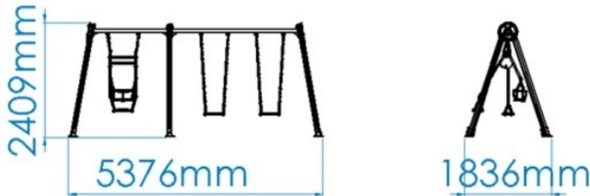
**INSTALAÇÃO / INSTALACIÓN / INSTALLATION / INSTALLATION**
